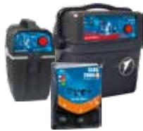
O impulso elétrico segue do eletrificador através de ligações e condutores procurando qualquer caminho disponível de volta à terra (animal, vegetação, etc.). Quando o animal toca no cercado, o impulso disponível nesse ponto corre através dele e completa o seu retorno através da terra.
