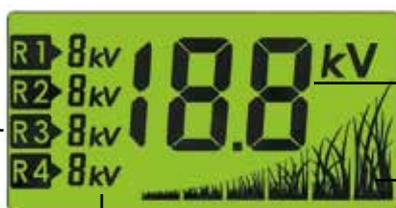
Informação da tensão em KV detetados pelos SENTINELAS (opção)
